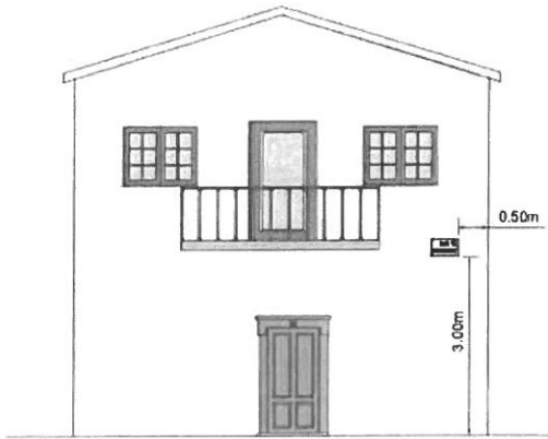
Fig. 1 – Colocação de placa em fachada
